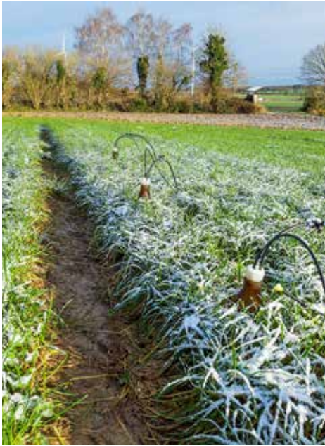
Installierte Saugkerzen-Messapparatur zur Bestimmung von Nitratausträgen mit dem Sickerwasser Foto: Rita Kopp
